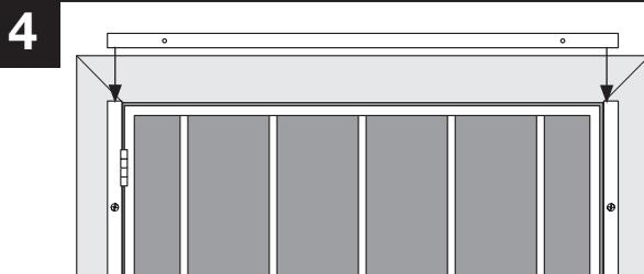
Coloque la jamba de travesaño superior (C) a través de la parte superior de las dos jambas de lado. Asegúrate de que hay un mínimo 1/8" espacio entre la jamba y la parte superior del marco de puerta, y la jamba esté nivelada.
