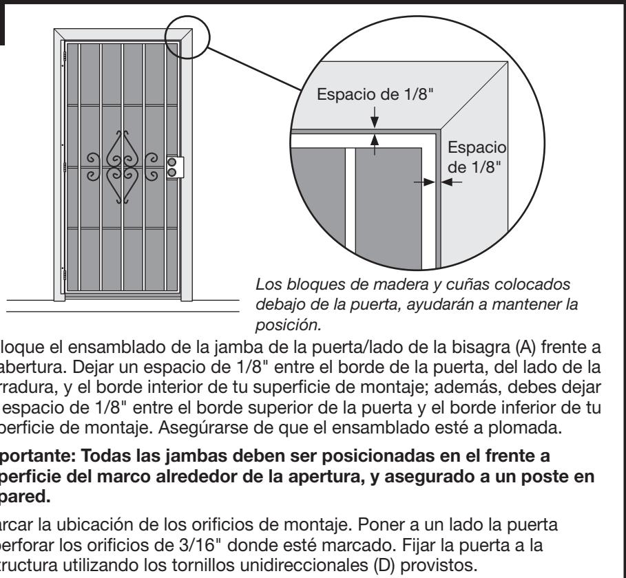
Coloque el ensamblado de la jamba de la puerta/lado de la bisagra (A) frente a la abertura. Dejar un espacio de 1/8" entre el borde de la puerta, del lado de la cerradura, y el borde interior de tu superficie de montaje; además, debes dejar un espacio de 1/8" entre el borde superior de la puerta y el borde inferior de tu superficie de montaje. Asegúrate de que el ensamblado esté a plomada.
