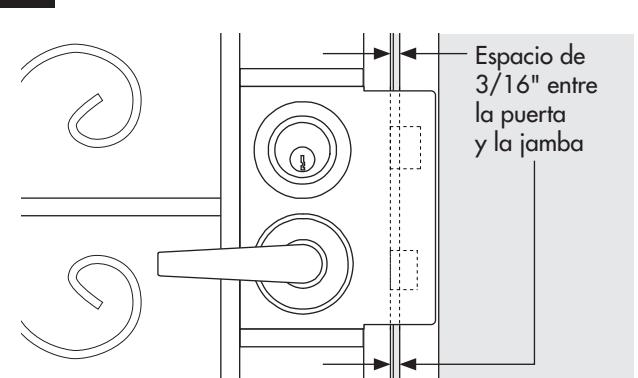
Con los pasadores del cerrojo extendidos, alinear los orificios de cerradura en la jamba del lado de la cerradura (B). Deje aproximadamente 3/16" de espacio entre la puerta y la jamba. Asegúrate de que el jamba esté a plomada, y la parte superior es el nivel de la parte superior de la jamba del lado de la bisagra.
